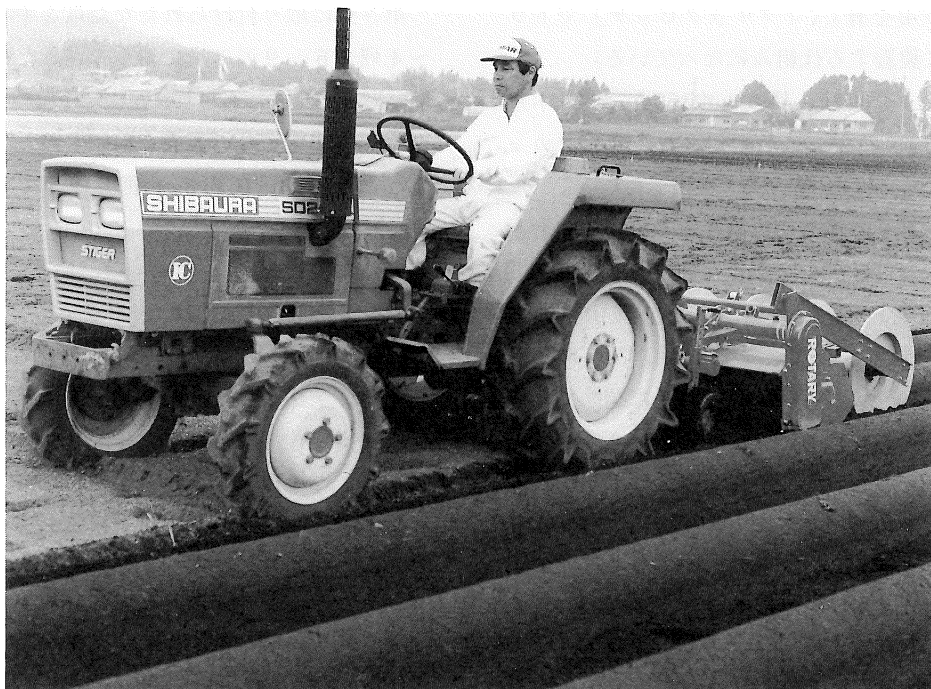
◀表面硬化装置による甘しょ畦立作業（九州農試 畑地利用部圃場）
