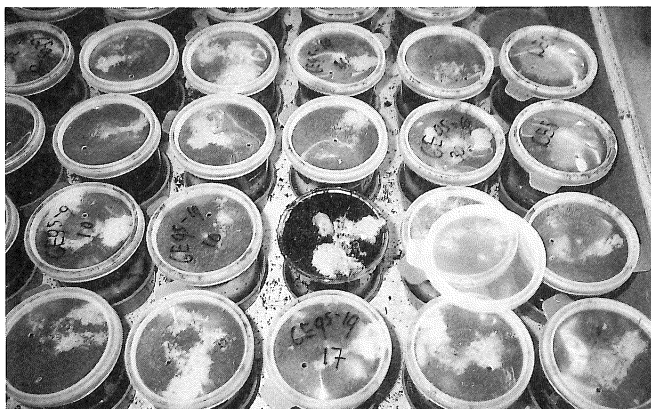
▲ポットにいもと汚染土を入れ蓋をして真下 9 週間 20℃ で置く (アグリコでの線虫抵抗性検定試験)
