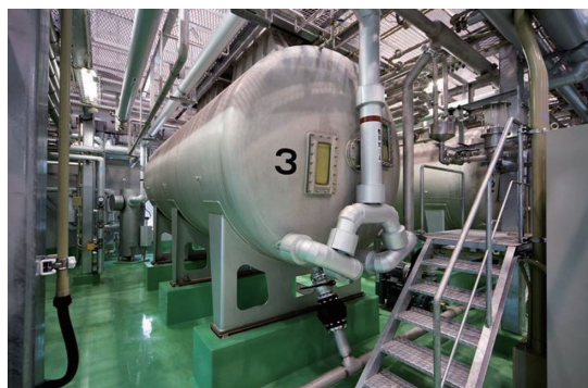
図2 弊社独自の江夏蒸留機（E－II型）
