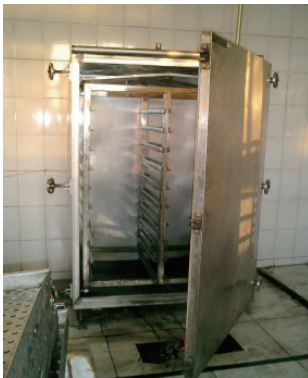
写真2 原料いもの箱形蒸し器
