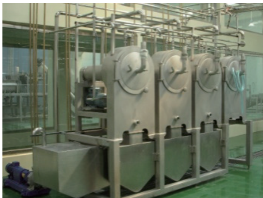
写真6 全自動の機械化された密閉式甘藷澱粉の製造現場
