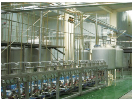
写真6 全自動の機械化された密閉式甘藷澱粉の製造現場
