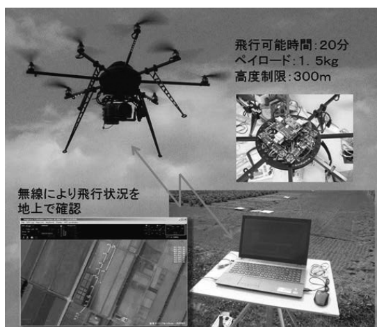
図1 ドローンによる撮影システム
