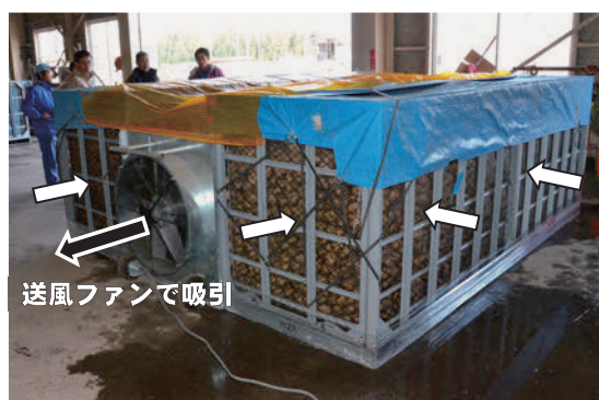
図4 強制通風乾燥装置を用いた種ばれいしょの通風乾燥の様子(左)と通風乾燥処理が塊茎の保菌率に及ぼす影響(右)
