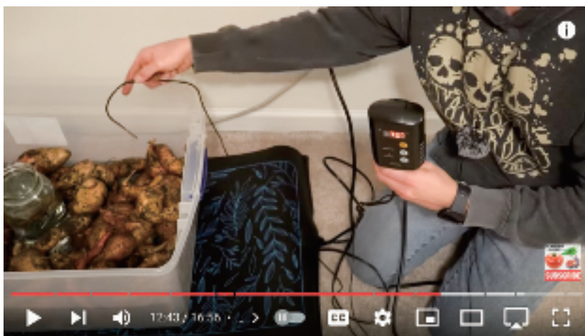
写真1 左、収納プラスチックケース、それに積み込んでいるサツマイモ、水入りの大口ガラス瓶、MG司会者右手に温度調節装置のセンサー。 中央、じゅうたんの上に育苗マットヒーターが引いてある。 右、MG司会者左手に温度調節装置。（サーモスタット）
