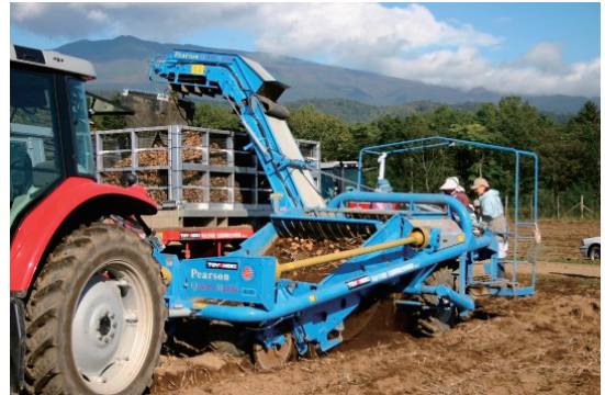
2畝エレベータ式収穫機 コンテナは5トンで伴走する
