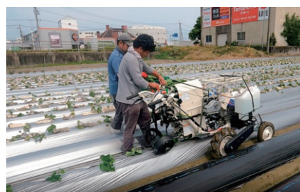
図7 改良後の移植機における長い葉柄の苗でミスが起こる原因
