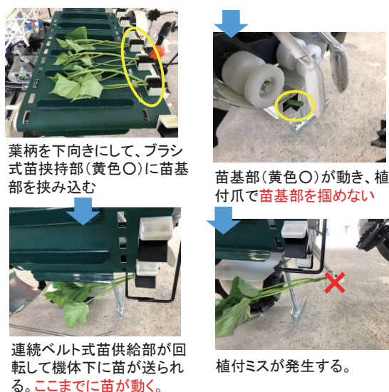
図4 移植成功率が低くなる原因と発生行程
