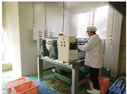
る。ドラムの内部に熱蒸気を投入し、それをそぎ落とす。熱源は干し芋加工用の蒸気ボイラーを使用できる。
