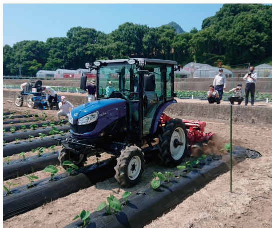
写真6 ハイクリアランス仕様トラクタによる土入れ作業（5月）
