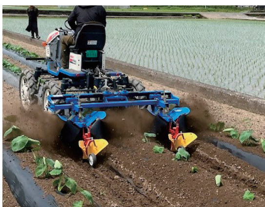
写真7 ハイクリアランス仕様乗用管理機による土入れ作業（6月）
