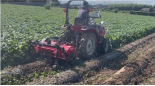
図5 自動高さ調整型つる刈り機の実証風景
