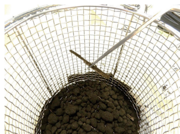
残渣をピンセットで計量用の容器（シャーレなど）にとりわけ
