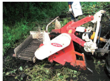
図Ⅲ-9 コンベア型掘取機
