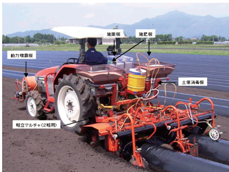
図Ⅲ-6 植付前作業の同時工程化技術の機械装備
