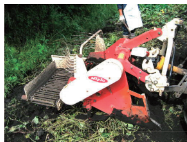
図Ⅲ-9 コンベア型掘取機
